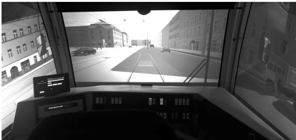
Rysunek 1. Wierna replika kabiny tramwaju Bombardier NGT6, z projekcją obrazu na trzy ściany kabiny, perspektywa ustawiona jest tak, by osoba siedząca na fotelu odbierała obraz jako spójny Źródło: opracowanie własne.
